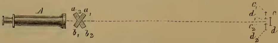
Figur 273. Schema zum Ophthalmometer.
